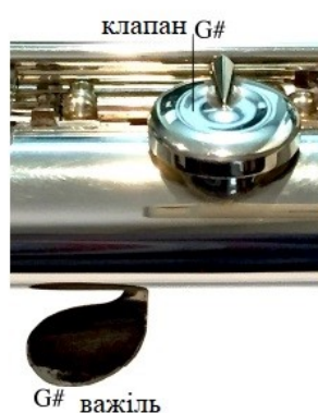
Приклад 2.2.ї. Механізм клапана G# стандартної концертної флейти (in C) (внутрішня сторона механізму) [263, с. 20].
