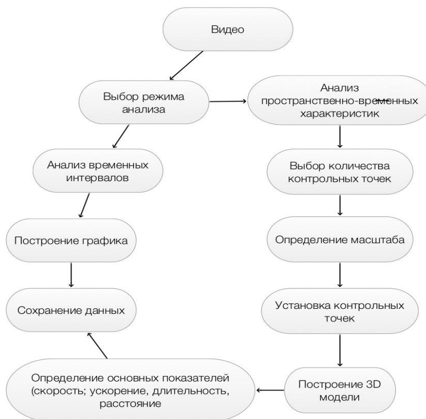
Рис. 1. Алгоритм работы компьютерной программы для биомеханического анализа
