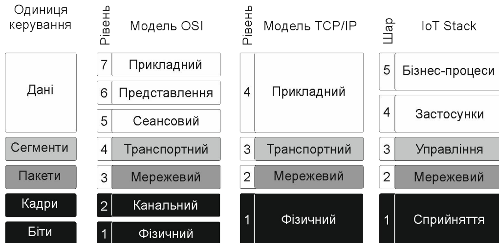
Рис. 20. Процес мережевої взаємодії відповідно рівням моделі OSI, моделі TCP/IP та шарам стеку IoT
