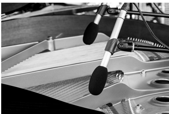
Мал. 46, приклад. Для запису фортепіано була використана мікрофонна техніка стереозапису. Два паралельні кардіоїдні мікрофони, розташовані на відстані менше 60 см один від одного і розміщені над середніми молотками, спрямованими на 45° вниз, і на піаніста.
